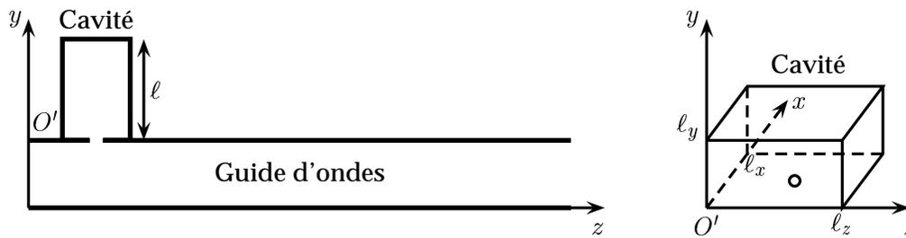
Figure 4 : Cavit  resonante coupl e au guide d'ondes.
