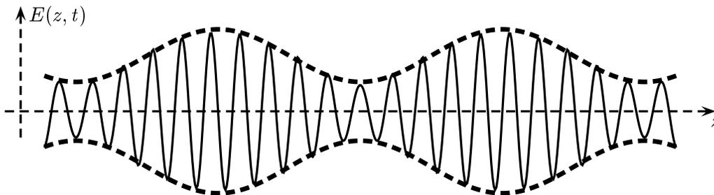
Figure 5 : Représentation schématique des variations du champ électrique dans le guide.
